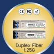
CTS-LC0020-SM SFP 1.25G, 1310nm/SM, 20K m. CTS-LC0040-SM SFP 1.25G, 1310nm/SM, 40K m. CTS-LC0080-SM SFP 1.25G, 1550nm/SM, 80K m.
