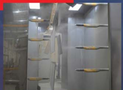
Powder coating improves durability of enclosures การเคลือบสีฝุ่นจะเพิ่มความแข็งแรงทนทานให้กับตู้
